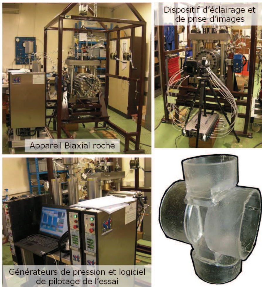
FIGURE 10 – Photographies du nouvel appareil biaxial roche lors du premier essai, du dispositif d'éclairage de l'échantillon par fibres optiques, et des trois générateurs de pression, ainsi que d'une membrane d'étanchéité en silicone devant protéger l'échantillon de l'huile de confinement.
