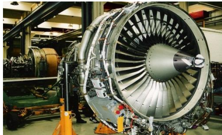
La motorisation du Comac 919 (moteur CFM Leap)
