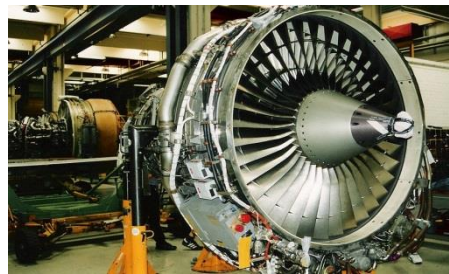
La motorisation du Comac 919 (moteur CFM Leap)
