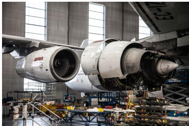
Gros porteur en motorisation Safran-GE / CFM 56.
