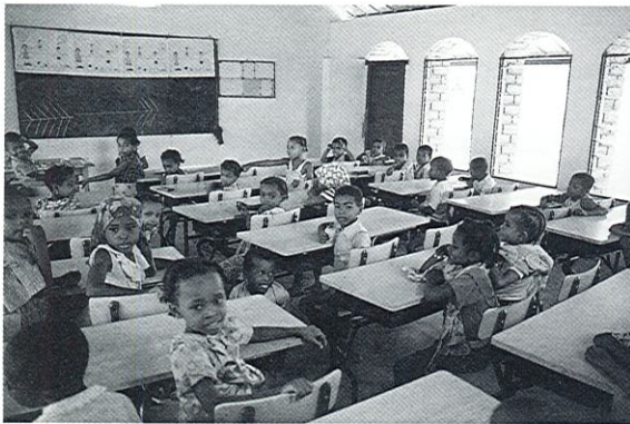
Ecoles primaires à Mayotte. Des murs pignons épais et deux arcatures pour des varangues latérales donnant de l'ombrage et une ventilation naturelle transversale.
