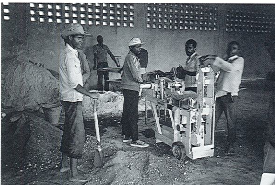
Séminaire de formation théorique et pratique au Burundi. Mise en application de solutions constructives en blocs de terre comprimée et toitures en tuiles micro-ciment vibré.
